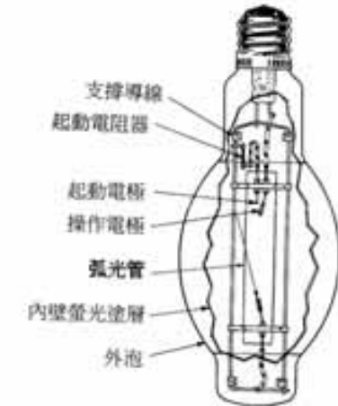
圖 4-31 水銀燈構造(IES Lighting Handbook-Reference Volume, 1984)
