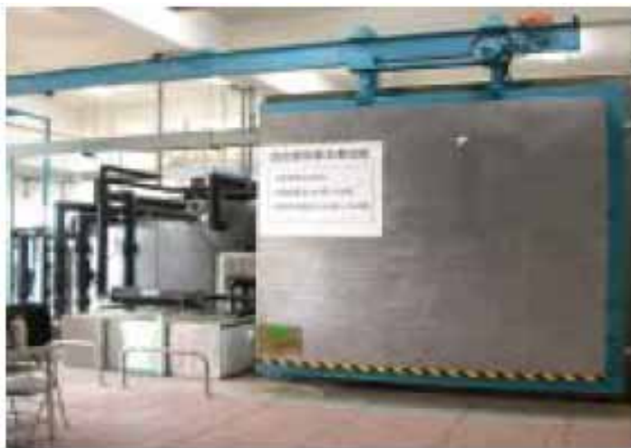
圖 5.4 大型減壓燻蒸及預冷庫
