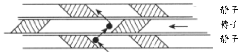
圖 3.22 渦輪幫浦內部轉子和靜子圓盤結構示意圖
