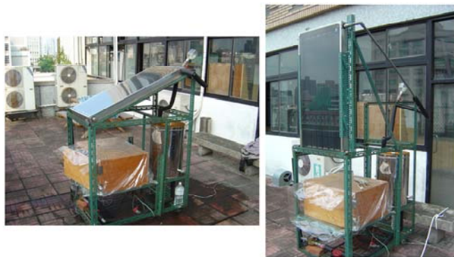
圖一 集熱板安裝為 30 度、90 度
