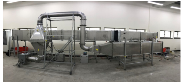
圖四. 濾網測試系統
